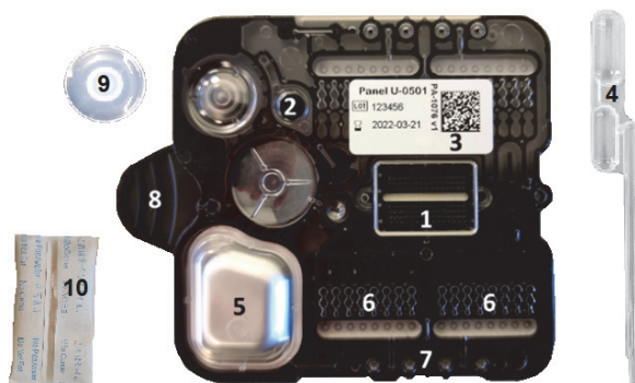
Abbildung 3: Eine Einweg-Testkassette zusammen mit einer Probenverschlusskappe und einer Transferpipette.
