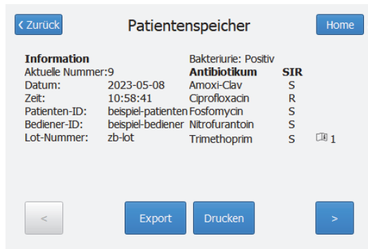
Abbildung 13: Beispiel eines Testergebnisses in [Patientenspeicher]. Verwenden Sie die Pfeile in der unteren linken und rechten Ecke, um zwischen den gespeicherten Testergebnissen zu navigieren.
