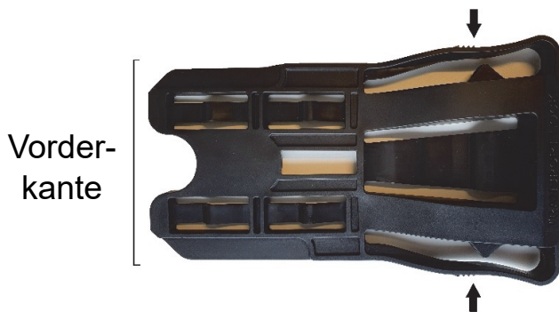
Abbildung 5: Draufsicht auf die Transportsicherung. Um die Sicherung zu entfernen/einzusetzen, drücken Sie die Kanten zusammen (siehe Pfeile), während Sie die Vorderkante einschieben bzw. herausziehen.
